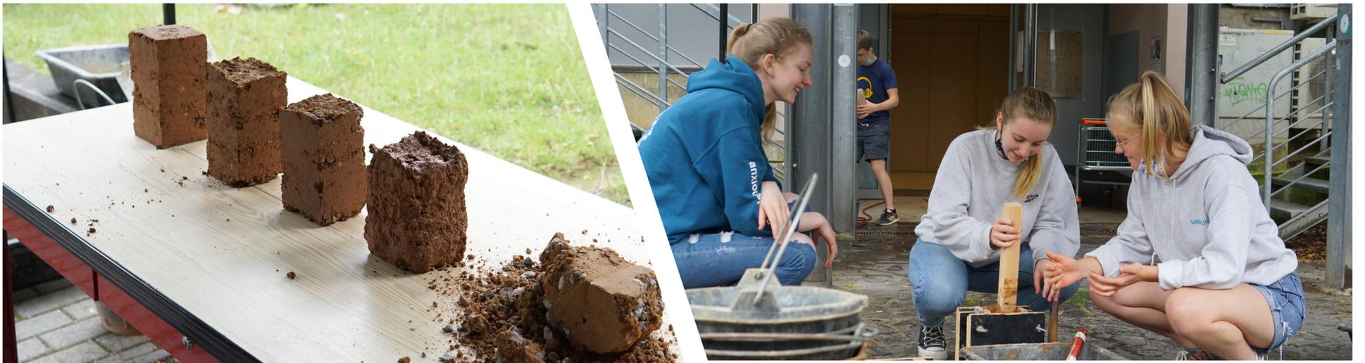
La matinée était consacrée à la réalisation d’échantillons afin de déterminer les bonnes proportions du mélange pour l’obtention d’un matériau adapté à la construction.
